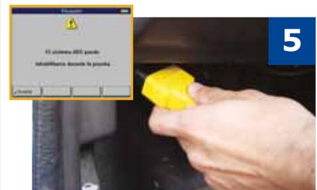
5 Si la comunicación no se establece, aparecerán en pantalla diversas indicaciones: revisar el estado de los conectores y las conexiones en el escáner y en el conector de enlace de diagnóstico (DCL); usar otro tipo de cable para la interfaz (se indica su número de identificación SAE); agregar al conector un determinado número de inserto; cargar un determinado cartucho de programa específico con la aplicación adecuada; etc.
